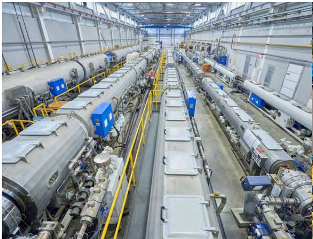
Площадка по производству многослойных труб до 1200 мм для водоснабжения и газификации, систем трубопроводов для промышленности, защиты электрокабельных сетей. Изготовление сварных фасонных изделий, полимерных колодцев, резервуаров, ЛОС и КНС
